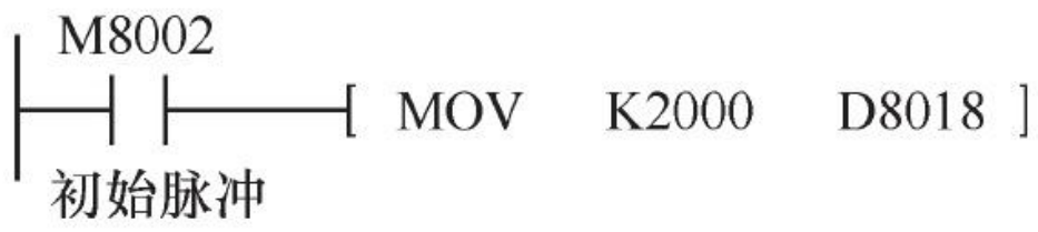
图 6-124 将年值改为 4 位需增加的梯形图程序
